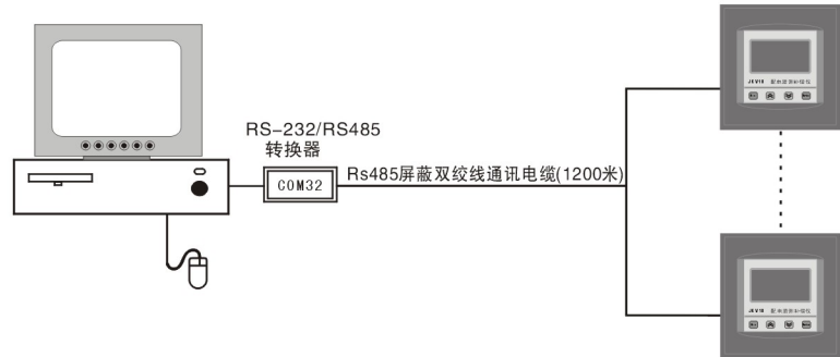
图2 一台微机与1至32台JKW-8构成有线通讯系统
